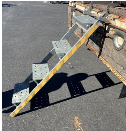
アシケン2 壊れたアルミ階段をカットして再利用
