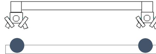
パイプを設置するときは、ジョイント
